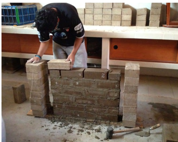
Figura 28. Construcción de Muretes
