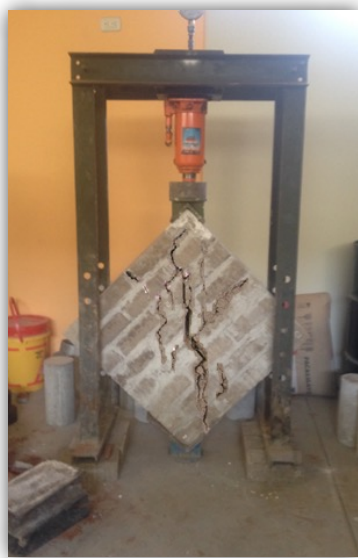
Figura 43. Forma de falla de los muretes
