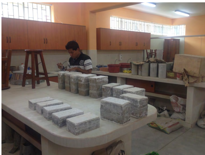
Figura 36. Pilas de albañilería de 2 y 3 hileras
