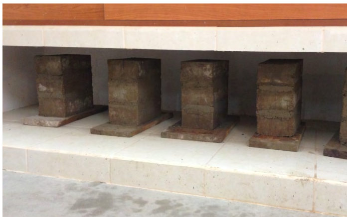
Figura 27. Pilas construidas de tres hiladas
