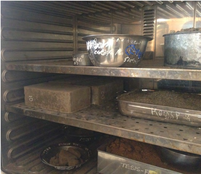
Figura 32. Unidades colocadas en horno
