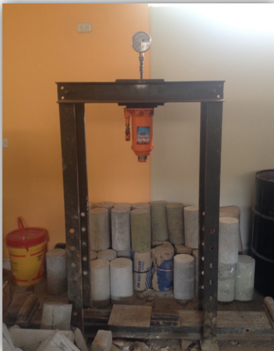
Figura 41. Máquina de compresión universal
