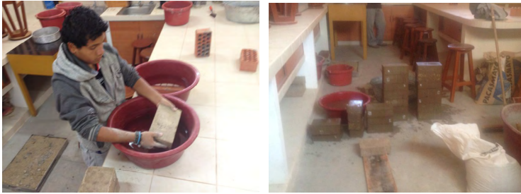
Figura 21. Humedeciendo las unidades de Suelo-Cemento
