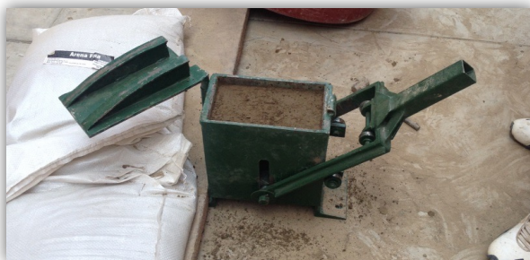
Figura 12. Mezcla depositada en la CINVA-RAM
