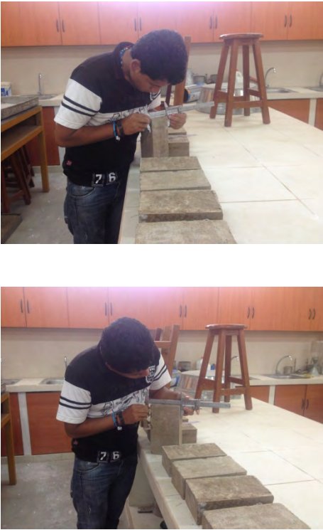
Figura 30. Medición de las unidades de suelo-cemento
