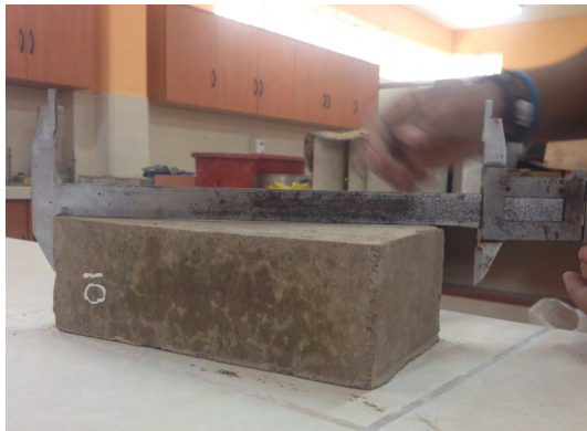
Figura 31. Ensayo de Alabeo
