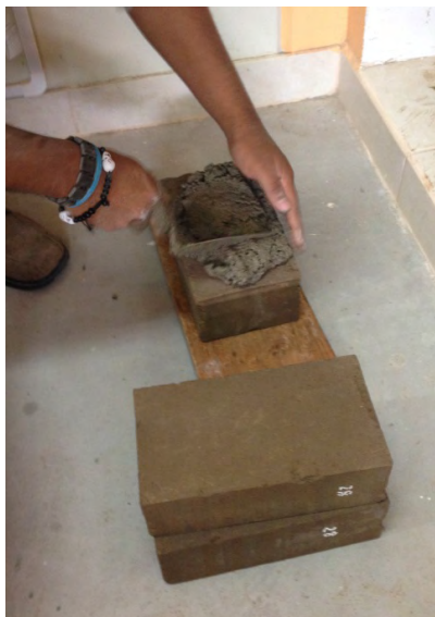
Figura 26. Construcción de Pilas
