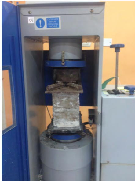
Figura 17. Pilas de albañilería sujeta compresión axial
