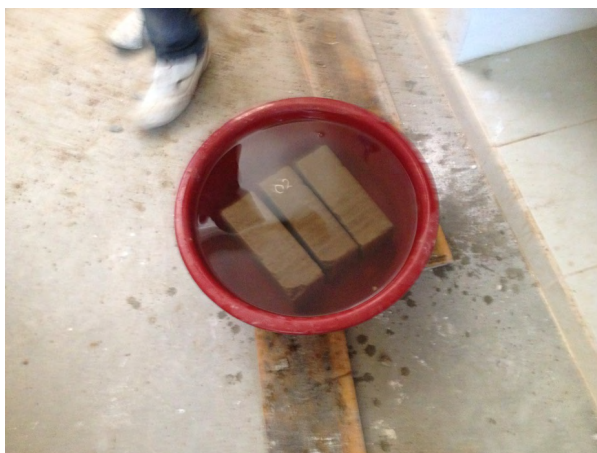
Figura 33. Unidades sumergidas 24 horas
