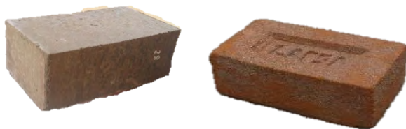
Figura 2. Ladrillo KK Artesanal (Izquierda) y Ladrillo Suelo – Cemento (Derecha)
