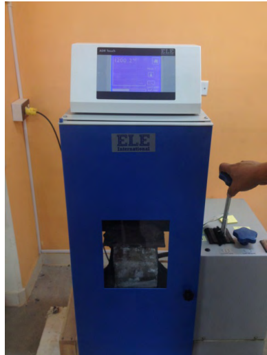
Figura 37. Máquina de compresión ELE International ADR Touch Head
