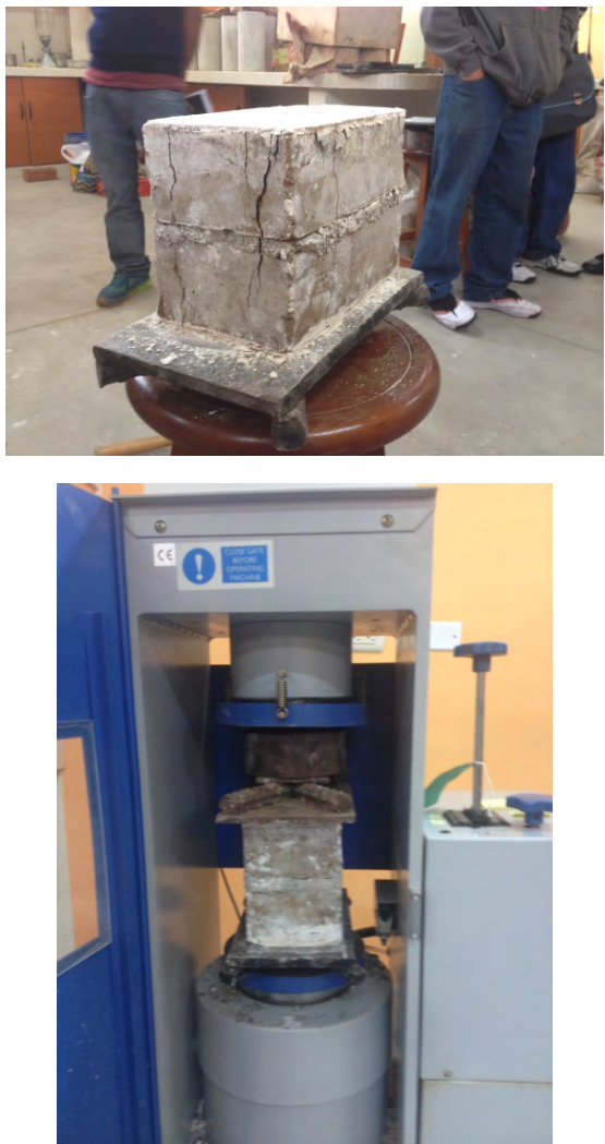
Figura 38. Ensayo y forma de falla para pilas de 2 hileras
