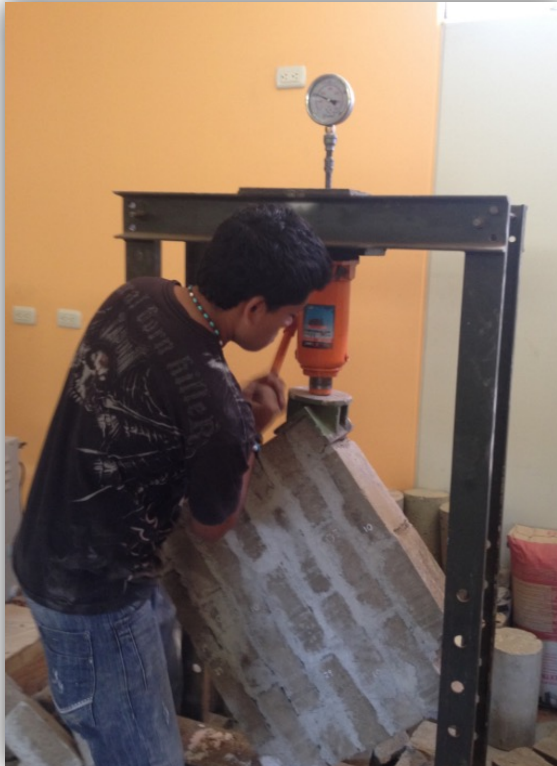
Figura 42. Aplicación de carga sobre murete
