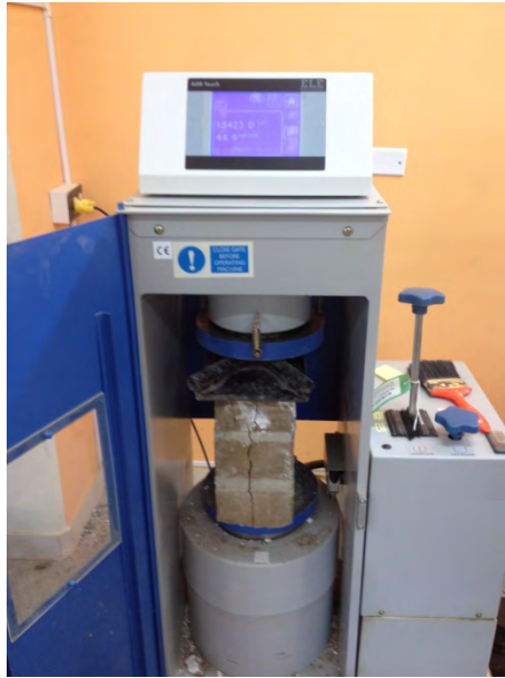
Figura 39. Ensayo y forma de falla para pilas de 3 hileras
