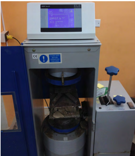
Figura 34. Unidad de albañilería ubicada en la máquina de rotura
