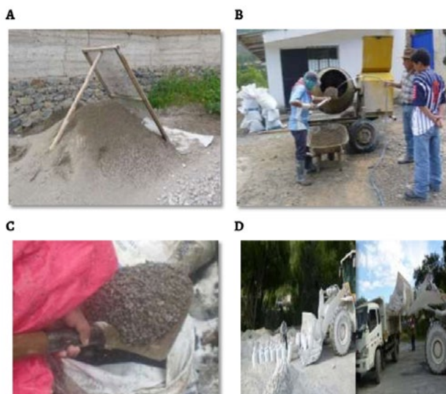
Figura 4. Etapas de acondicionamiento de roca caliza. A: Separación por tamaño mediante tamizado. B: Purificación de áridos por lavado. C: Verificación de granulometría de la grava. D: Preparación para transporte a Pastoruri.
