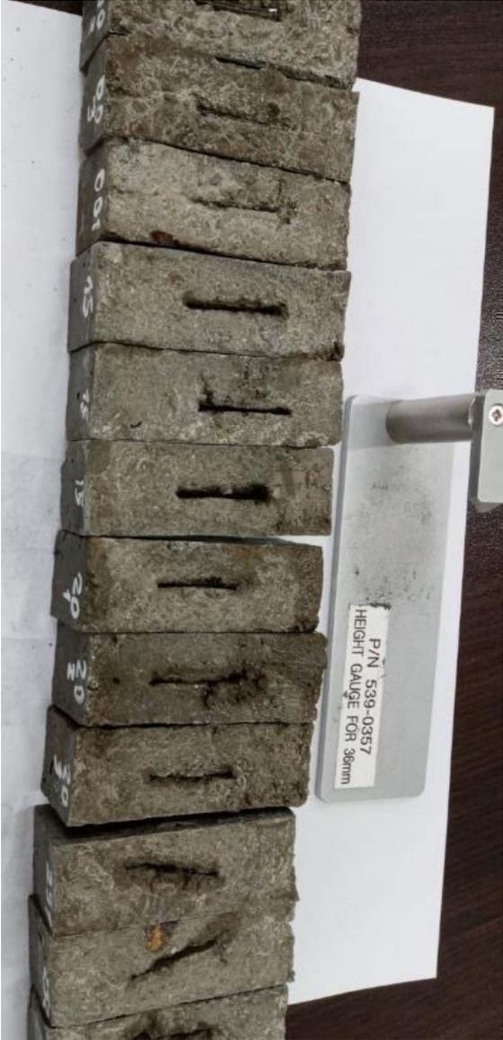
Figura 18. Colocación de muestra para cargar al microscopio.
