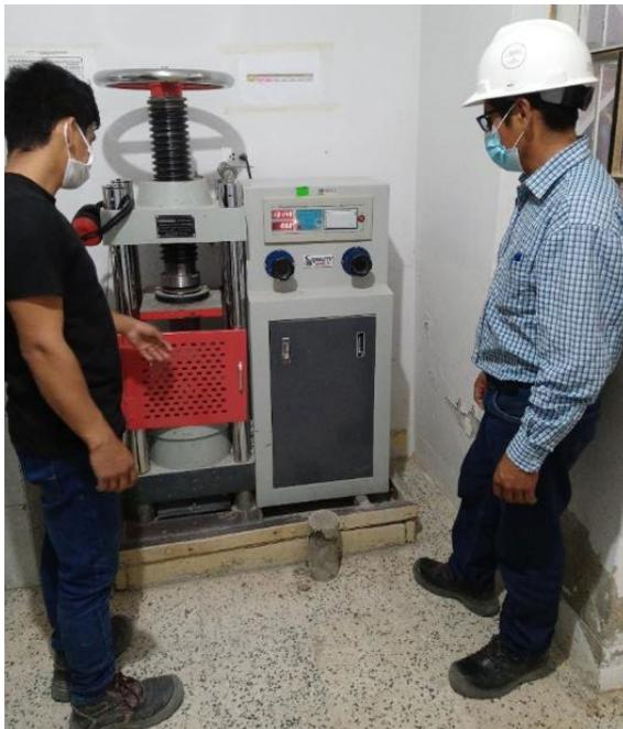
Figura 20. Ensayo a compresión de probetas cilíndricas LEM-UNI
