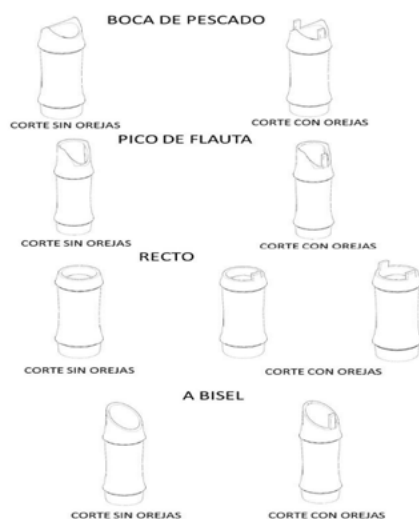
Figura 20. Cortes para uniones entre culmos de GaK.
