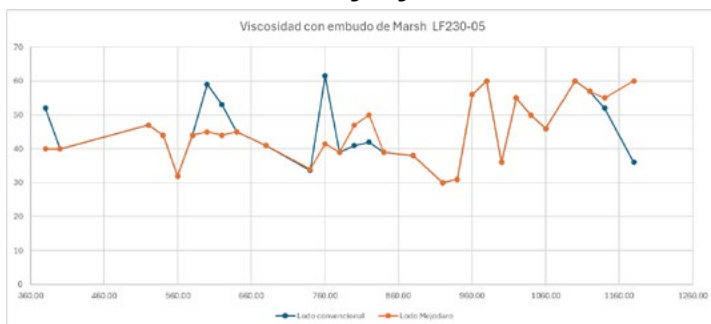
Figura 13. Variación de la viscosidad Marsh con la profundidad – Pozo LF230-05
