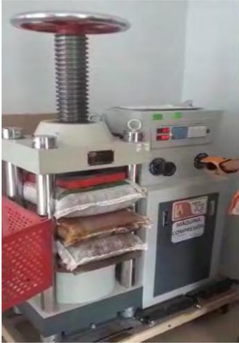
Figura 10. Ensayo a compresión del adobe tradicional
