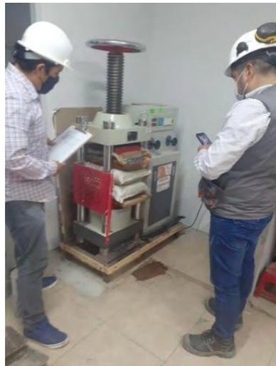
Figura 9. Ensayo a compresión del material cohesivo
