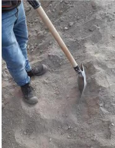
Figura 2. Extracción de suelo cohesivo
